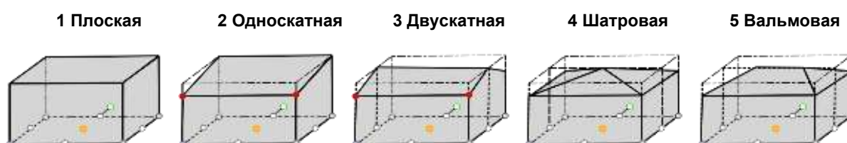
Рисунок 4.1 – Форма крыши здания по его типу
